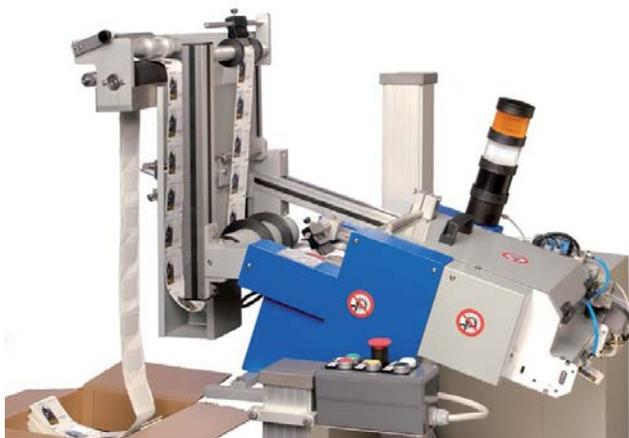
Whizzy Roll è il feeder per il taglio e la distribuzione di materiale in bobina - cartaceo o film plastico - a nastro continuo. In seguito alla lettura di una tacca, la macchina riceve un segnale di stop e procede al taglio del prodotto che viene quindi distribuito. Il taglio è inoltre possibile senza la lettura della tacca tramite un encoder, impostando i parametri tramite un tastierino opzionale.
